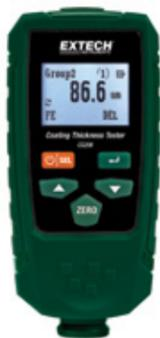
**CG204 Comprobador de espesor de revestimiento**
