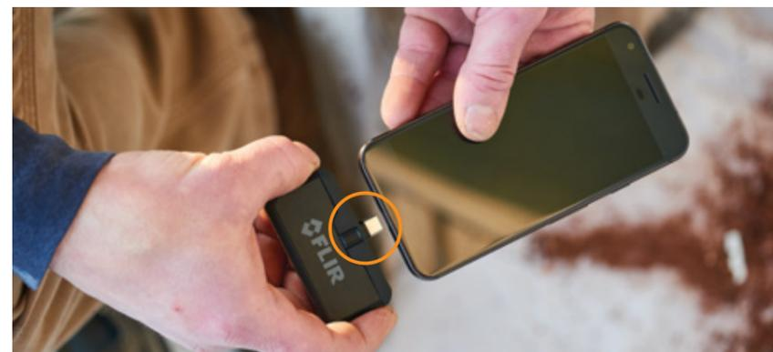
OneFit adapta su cámara de la serie FLIR ONE Pro para que se ajuste a prácticamente cualquier funda de teléfono.
